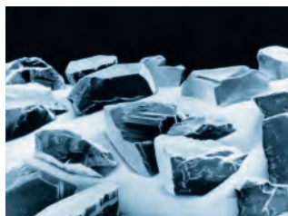
Fresa de diamante Kulzer. Integración y distribución óptima de las partículas de diamante.
