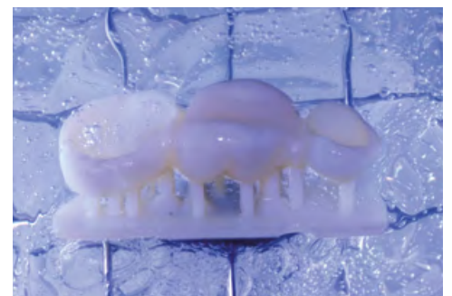
6. Debemos enjuagar correctamente las piezas impresas con alcohol isopropílico, por un tiempo no mayor a 5 min para evitar la disolución del material y posteriormente debemos secar perfectamente con aire presurizado.
