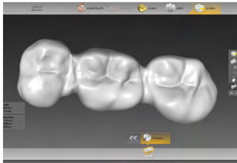
2. Exportación de la restauración en formato STL de máxima calidad para ser llevado a software de cálculo de intersección de planos (slicer).
