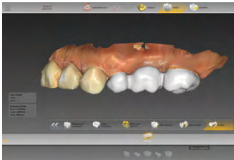
1. Diseño de la prótesis fija provisional, realizado en software de diseño a partir de un escaneo de las preparaciones dentales.
