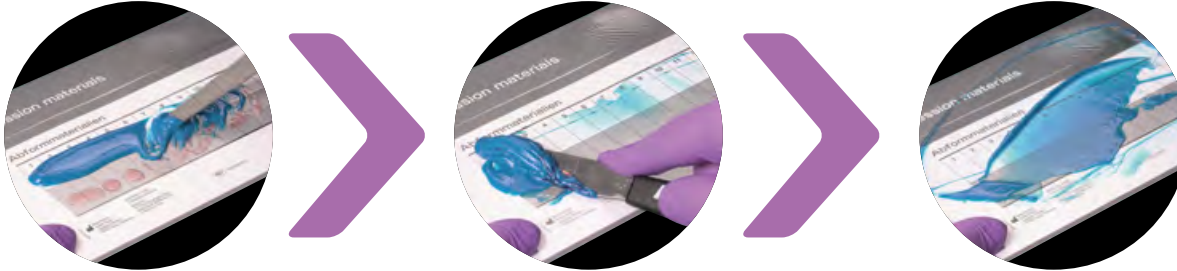
Fig. 61 - 63: Pre-mezcla con movimientos circulares, tome la mezcla con la espátula y extienda ampliamente.
