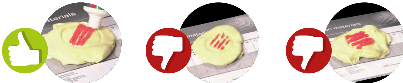
Fig. 49 - 51: Hilos correctamente dosificados (izquierda). En comparación, los hilos dispensados de forma desigual y demasiado delgados (centro), y demasiado gruesos (derecha) respectivamente.
