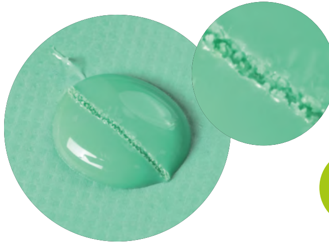
Fig. 22: La ausencia de una capa no polimerizada (capa de dispersión) muestra la compatibilidad de los materiales utilizados.
