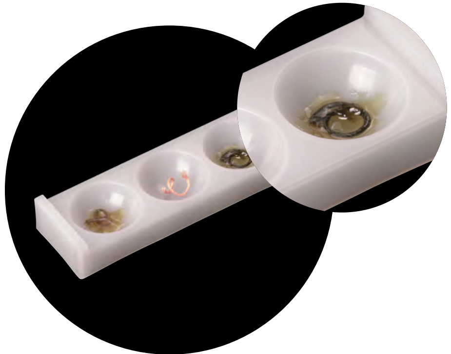
Fig. 26: En el espacio izquierdo: hilo no impregnado, empapado en sulfato férrico (sin decoloración). En el espacio central: hilo pre-impregnado con epinefrina, sin impregnado adicional (rosa). En el espacio derecho: hilo preimpregnado con epinefrina, adicionalmente impregnado con sulfato férrico (coloración azul / negra debido a la interacción).
