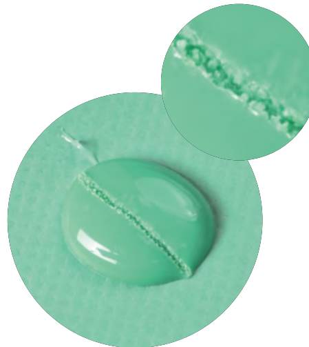
Fig. 38: La ausencia de una capa no polimerizada (capa de dispersión) muestra la compatibilidad de los materiales utilizados.
